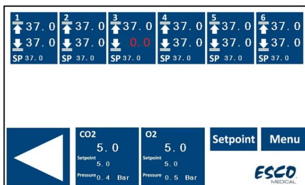
Obrázek 14.4 Zobrazení poruchy teplotního čidla na hlavním displeji vícekomorového IVF inkubátoru MIRI® TL6
