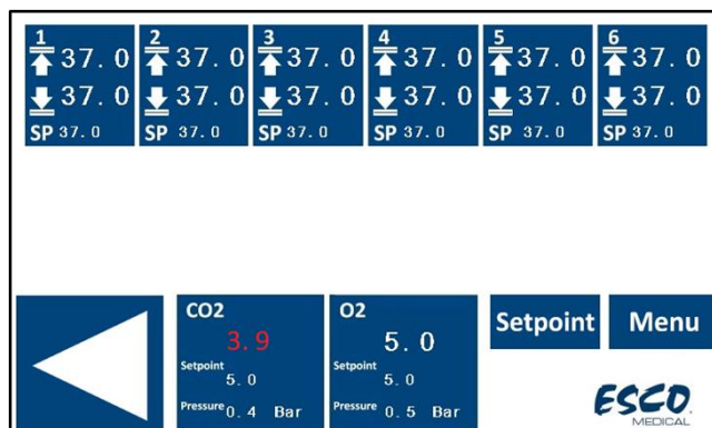
Obrázek 14.5 Zobrazení výstrahy nízké koncentrace CO 2 na hlavním displeji vícekomorového IVF inkubátoru MIRI® TL6
