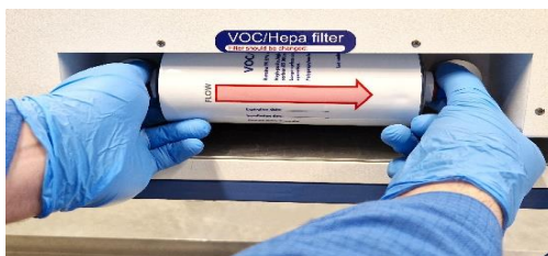
Obrázek 12.2 Postup vkládání a vyjímání filtru VOC/HEPA
