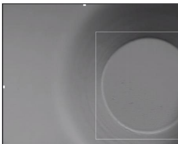
Obrázek 20.27 Příklad nesprávné polohy jamky na obrazovce zobrazení kamery
