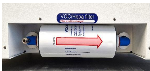
Obrázek 12.3 Správně nainstalovaný filtr VOC/HEPA
