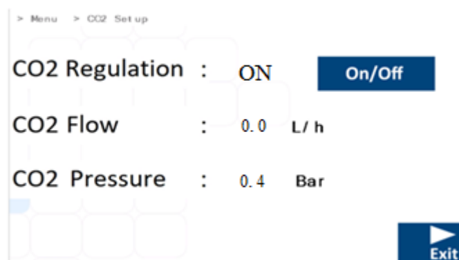
Obrázek 16.2 Zobrazení podnabídky nastavení CO 2 ve vícekomorovém IVF inkubátoru MIRI® TL6 a MIRI® TL12
