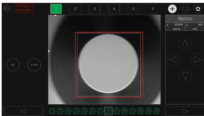
Obrázek 20.30 Poloha jamky uvnitř vyznačené hranice čtverce
