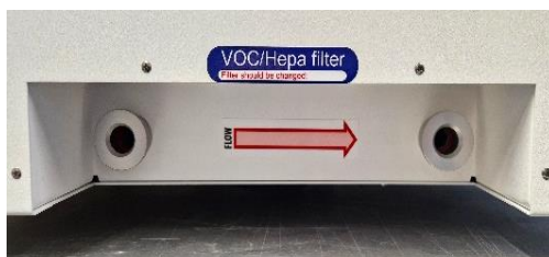
Obrázek 12.1 Šipka průtoku na vícekomorových IVF inkubátorech MIRI® TL6 a MIRI® TL12
